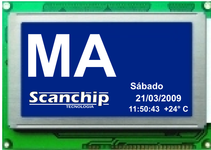
MA - Elevador em manutenção
